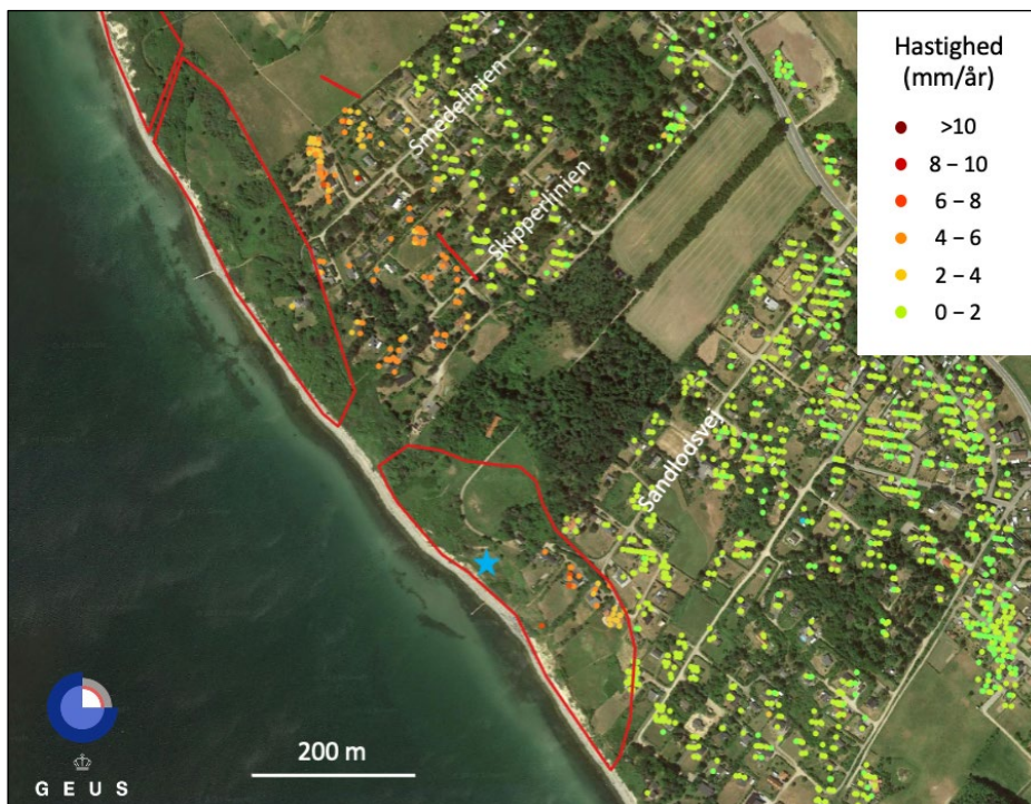
Figur 2: Satellitbillede af sommerhusområderne sydvest for Nostrup. De farvede prikker viser bevægelsesdata fra EGMS i perioden 2015–2021. Det nyopdagede skredområde omfatter de nedre dele af Smedelinjen, Skipperlinjen og Sandlodsvej, hvor de orange-røde prikker indikerer bevægelse på 5–10 mm/år. De røde optrukne linjer viser utydelige lineamenter, som kan være dannet ved skredbevægelse. Placeringen af et mindre skred i marts 2020 er markeret med den blå stjerne.
